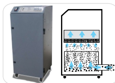
Sistema de Extracción (con filtros)
