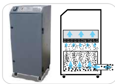
Sistema de Extracción (con filtros)
